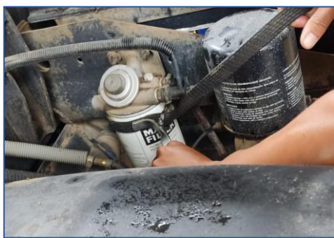
(processo de remoção do filtro)
