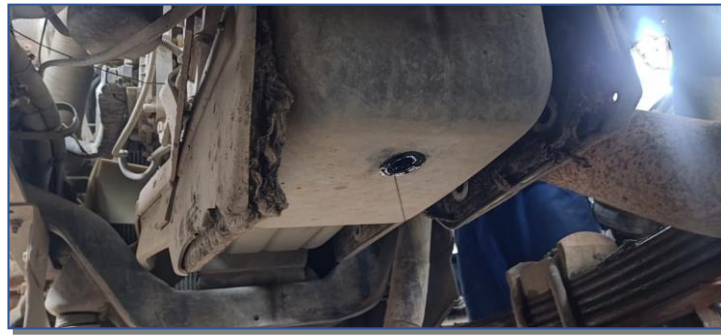
(Cárter; localizado abaixo do motor)
