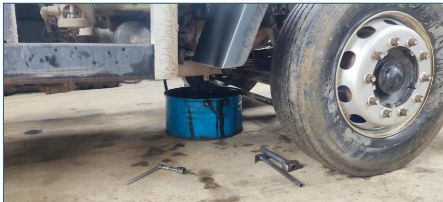
(Durante a drenagem do óleo do motor)
